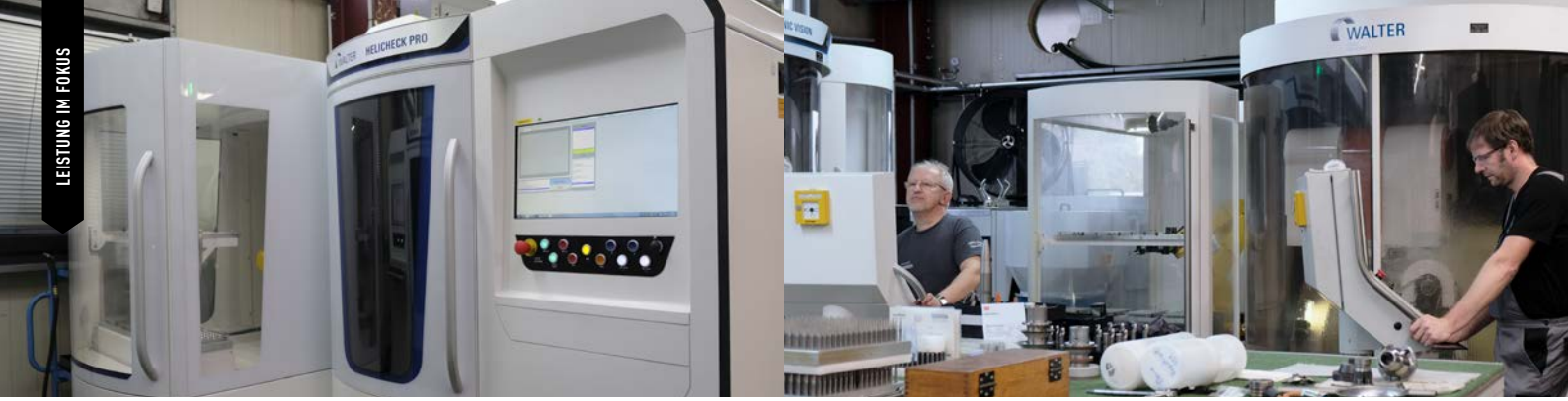
Helicheck Pro-Maschine zum vollautomatischen Messen von Werkzeugen
