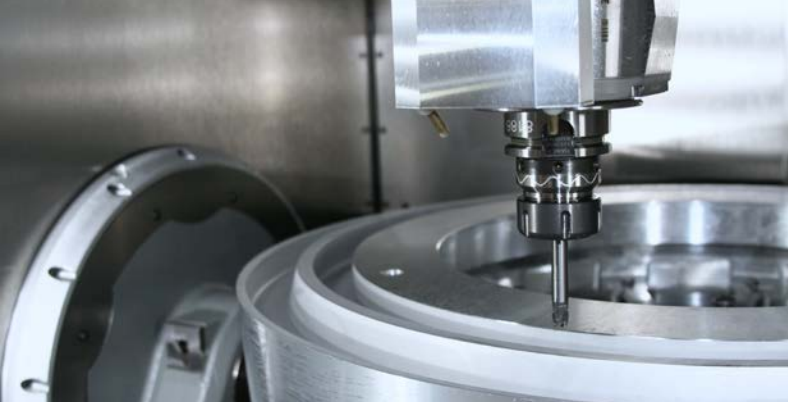
Vorbereitung einer fünfachsig Bearbeitungsmaschine
